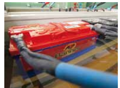
De batterijen brengen een groot deel van de test door in een waterbad met een constante temperatuur van 25°C.
